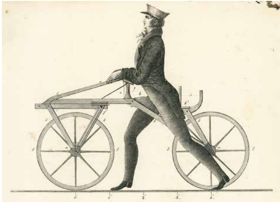
Abbildung aus der technischen Beschreibung der Laufmaschine von Karl von Drais, publiziert im Herbst 1817. Damit Nachbauer es nicht allzu leicht hatten, verdeckte der Fahrer auf der Zeichnung mit seinem Bein die Bremse.
