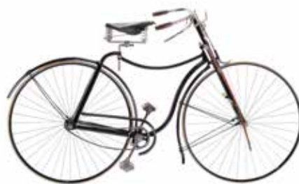
Sicherheitsniederrad „Rover III“, um 1888. Eine Gerte am Lenker diente zur Abwehr angriffslustiger Hunde.
